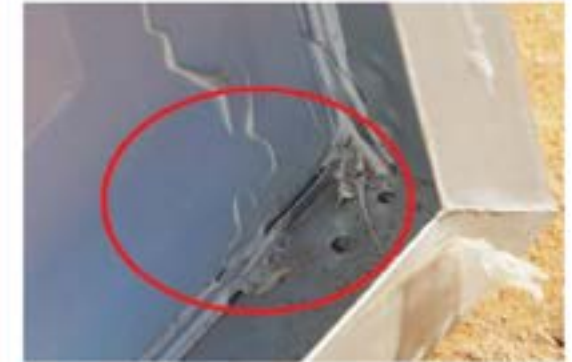
فقدان الترابط الميكانيكي بين أجزاء اللوح الشمسي
