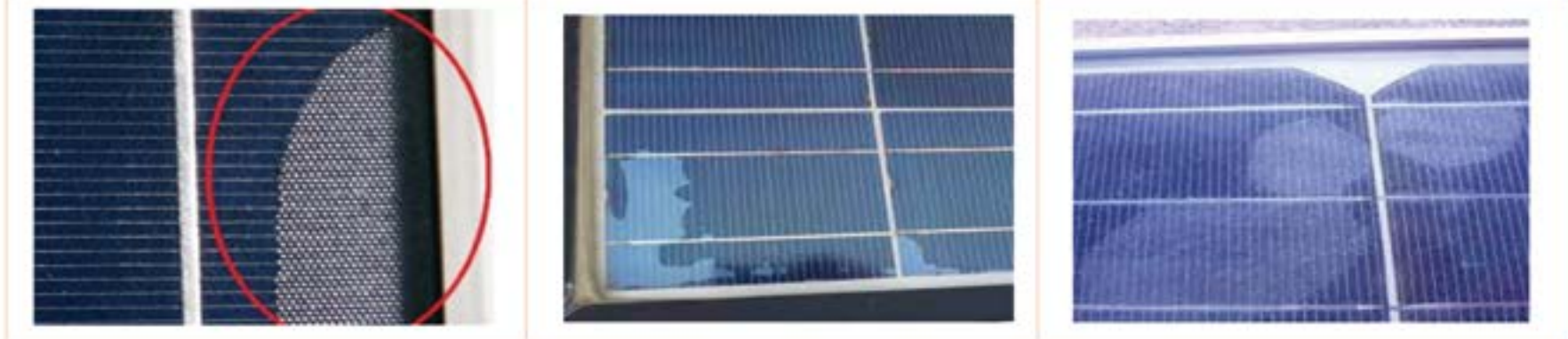
النفقات التي تشكل معرا دائما لتوصيل الخلايا الشمسية في اللوح الشمسي مع حواف اللوح (إطار اللوح)
