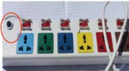
عدم وجود قاطع حماية للتوصيلات ذات 4 منافذ أو أكثر
